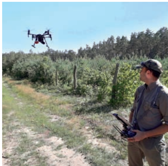
Autor tekstu obsługujący drona DJI Matrice 210 V2 z kamerą wielospektralną Micasense RedEdge MX. Fot. Archiwum
