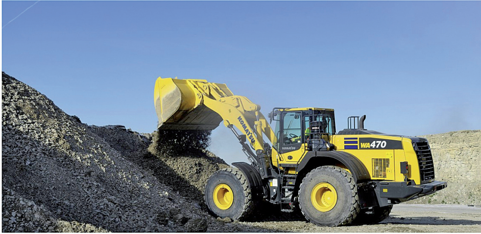
Rysunek 4.11. Ładowarka o masie 25 ton pracująca w kopalni odkrywkowej kruszyw (cena zakupu około 220 000 Euro), (Komatsu, 2017)
