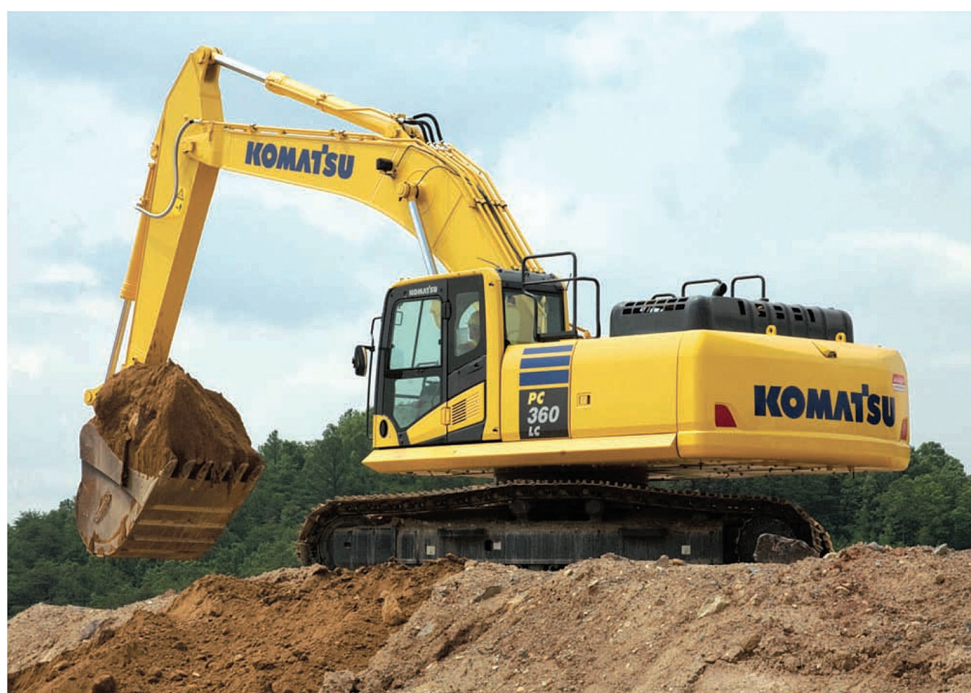
Rysunek 4.10. Koparka jednoczyniowa o masie 35 ton pracująca w kopalni odkrywkowej kruszyw (cena zakupu około 230 000 Euro), (Komatsu, 2017)
