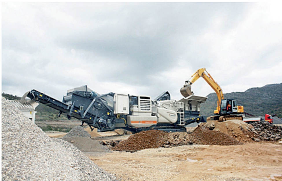
Rysunek 4.14. Kruszaraka mobilna o masie 42 ton pracująca w kopalni odkrywkowej kruszyw (cena zakupu około 485 000 Euro) (METSO, 2017)
