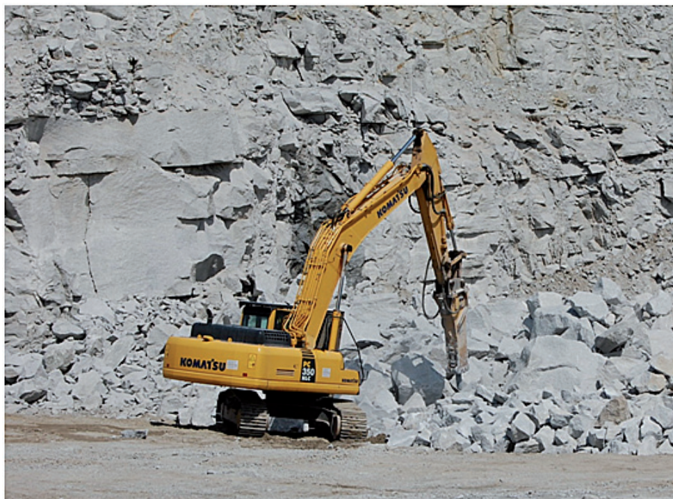
Rysunek 4.8. Eksploatacja lądowa skał litych średnio i słabo związanych za pomocą młota hydraulicznego (fot. M. Zajączkowski)
