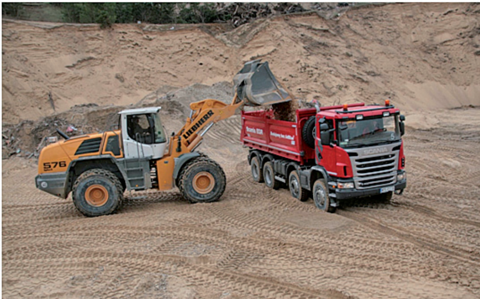
Rysunek 4.12. Samochód ciężarowy do transportu kruszyw o ładowności 17 ton pracujący w kopalni odkrywkowej kruszyw (cena zakupu około 110 000 Euro), (KH-KIPPER, 2017)
