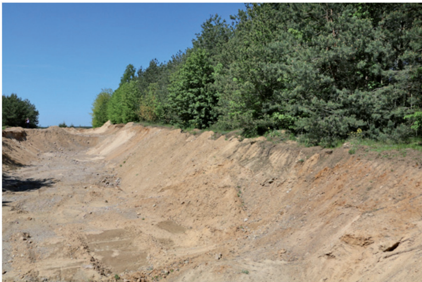
Rysunek 4.3. Skarpa wyrobiska odkrywkowego ukazująca profil utworów piaskowo-żwirowych zalegających pod gruntami leśnymi (fot. M. Zajączkowski)
