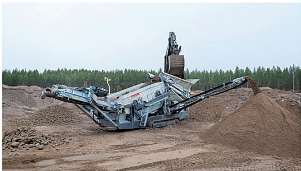
Rysunek 4.13. Przesiewacz mobilny o masie 26 ton pracujący w kopalni odkrywkowej kruszyw (cena zakupu około 260 000 Euro), (METSO, 2017)
