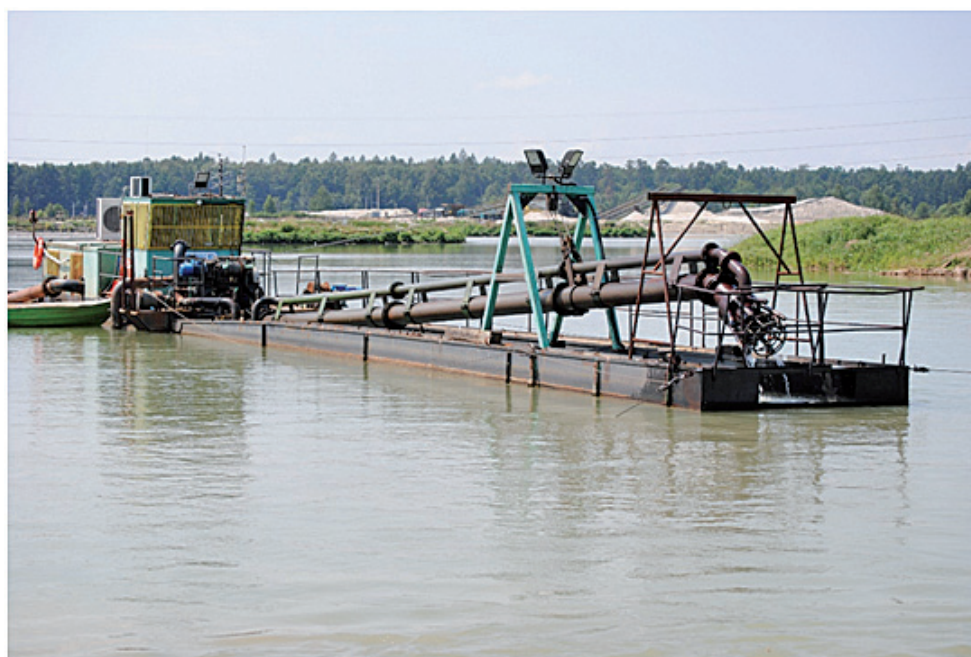
Rysunek 4.9. Eksploatacja spod lustra wody skał luźnych za pomocą koparki pływającej (fot. M. Zajączkowski)
